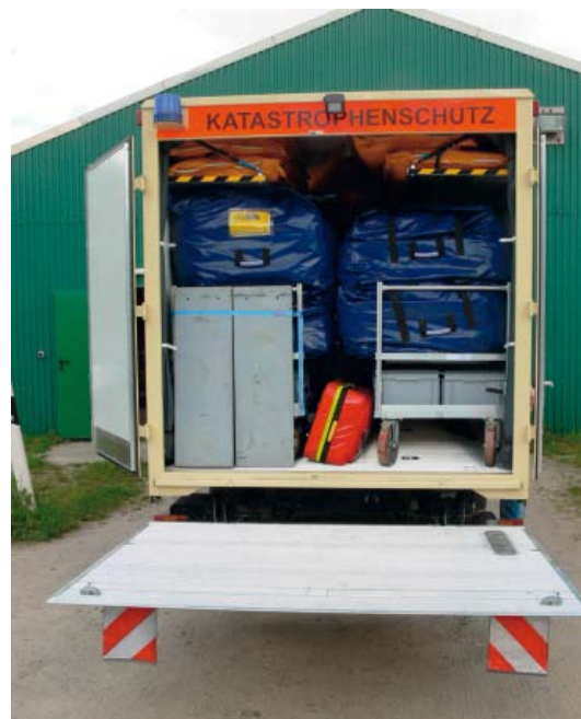
Abb. 2: Geräteraum mit Einsatzmaterial zur Einrichtung eines Behandlungsplatzes
